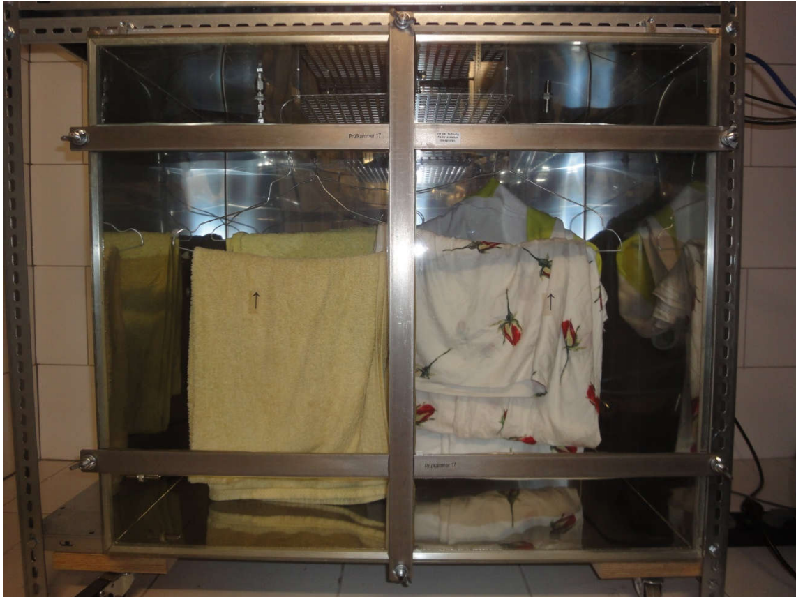
Abb. 2: Probe W2 - Maschinenwäsche schleuderfeucht in der Prüfkammer
