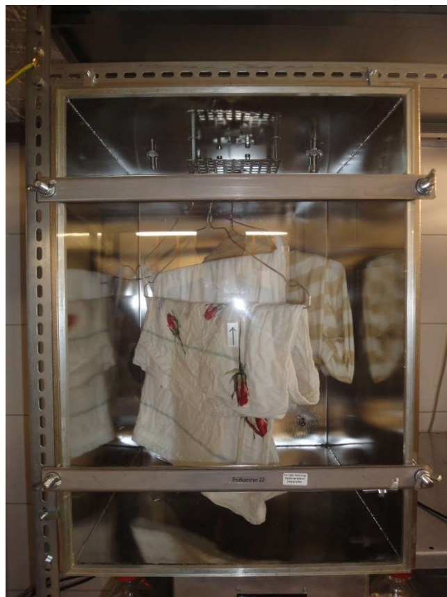
Abb. 3: Probe W3 - Handwäsche tropfnass in der Prüfkammer
