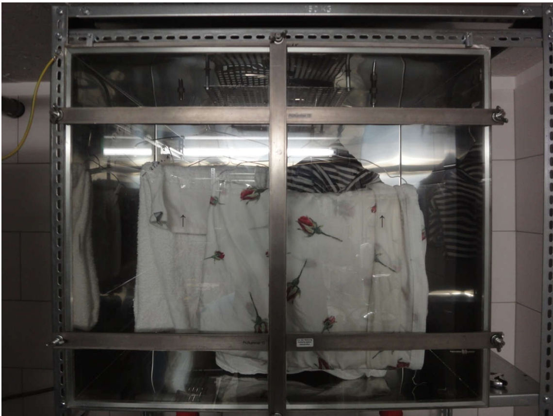
Abb. 1: Probe W1 - Maschinenwäsche schleuderfeucht in der Prüfkammer
